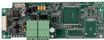
**PREVIDIA-C-COM** ofrece dos puertos RS232 y dos puertos RS485 donde conectar comunicadores remotos mediante los protocolos indicados en la tabla.
